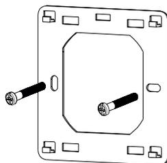
**3** Закрепите металлическую планку на монтажной коробке.
