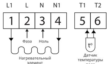
Схема подключения терморегулятора
