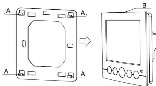
**2** Отсоедините металлическую планку от терморегулятора, отщелкнув защелку вверху терморегулятора и потянув металлическую планку вниз.
